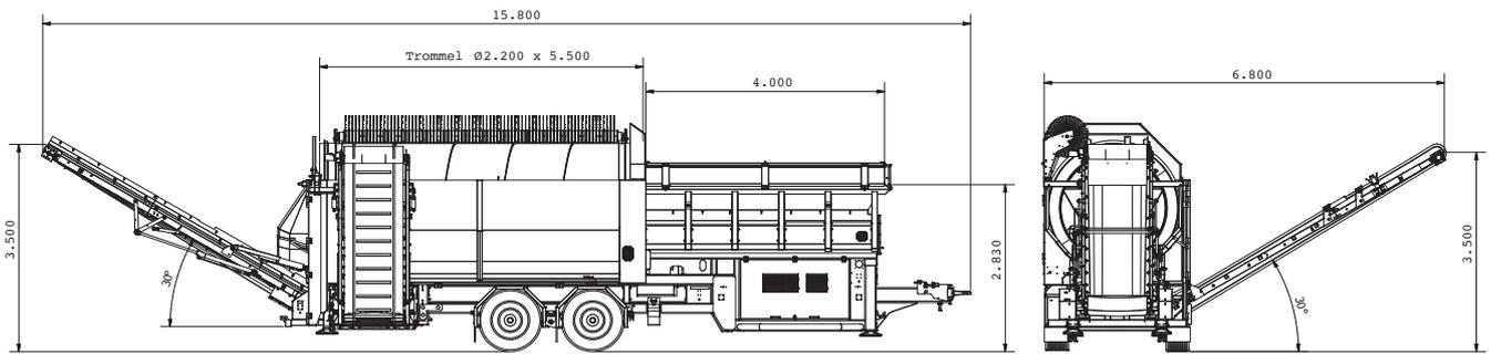
Mit einem Trommeldurchmesser von 2.200 mm und einem Bunkervolumen von 6,5 m<sup>3</sup>, sowie Bänderabwurfhöhen von 3.500 mm setzt die **Siebo 6000** neue Maßstäbe. Sie ermöglicht eine hohe Durchsatzleistung bei niedrigen Betriebskosten. Innovativ in der Klasse ist die neueste **Abgastechnologie EU**
