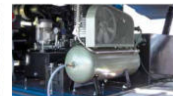
Kompressor zur Reinigung
